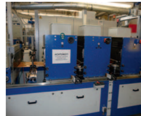
Abb.: Schweißstationen u. Kühlpresse, B + K
