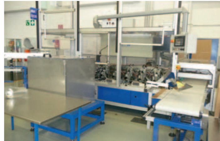
Abb.: Spezielle Anlage ebenfalls von B+B zum einschweißen der Ausgießer.
