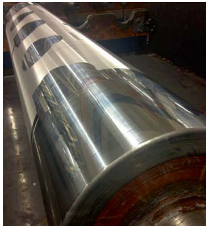
Abbildung: Gravierter und verchromter Tiefdruckzylinder
