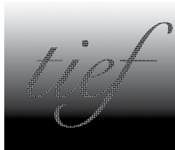
Abbildung: Schriften und Nöpfchen auf einem Tiefdruckzylinder
